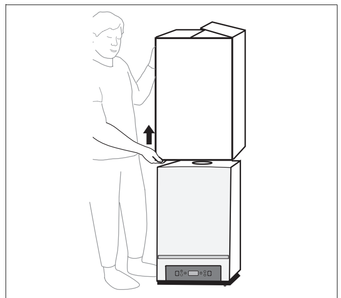
fig. 2 Verpakking van cv-toestel verwijderen
